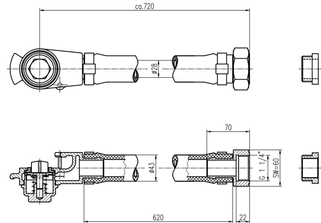
Bei Bestellung angeben: Schlauchkupplung mit Ventil
